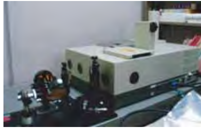
Компактный FTIR для измерения концентрации CO_2 .
